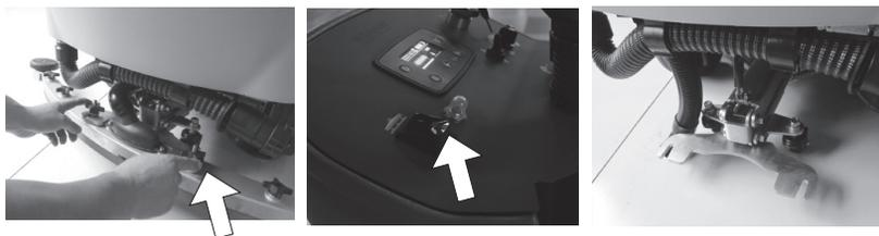
2. 机器清洗不同的地面，吸水扒与地面接触高度也不同，如地板砖、油漆、石材地面为：56MM~57MM；水泥地面为：55MM~56MM；调试方法如图调整吸水扒万向轮高低，吸水扒与地面接触的高度是从地面到吸水扒支架板下沿为准如图所示。
