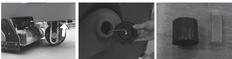
12. 在清水箱排干后，装上清水注入口上盖，并将排污管装回原位。
