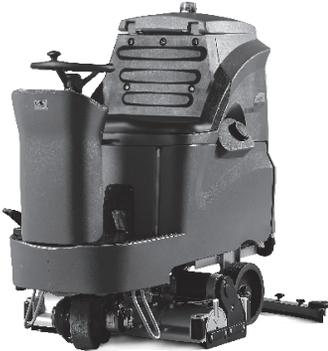
机器的清洗部件为：清水箱、污水箱、滚刷、吸水扒组件，一台吸水马达和驱动电机。
