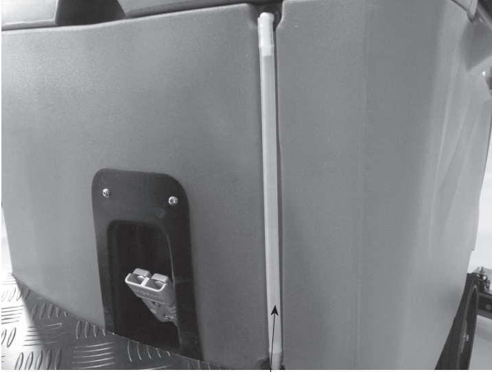
清水箱水位透明管
